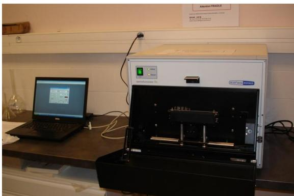
Photo 5 : Spectrofluorimètre SAFAS FLX du projet KarstEAU, et échantillons d'eau prélevés sur le terrain
