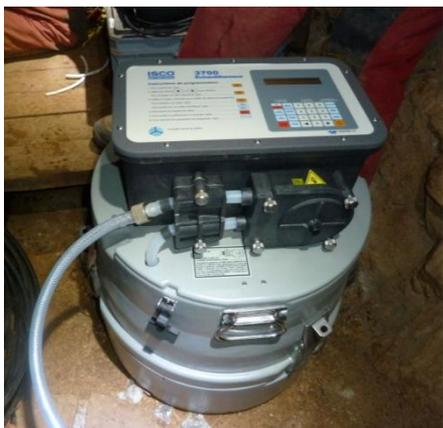
Photo 4 : Préleveur automatique type ISCO au barrage souterrain de Port Miou
