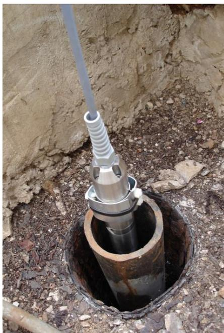
Photo 1 : Fluorimètre dans le tube de forage de Bestouan
