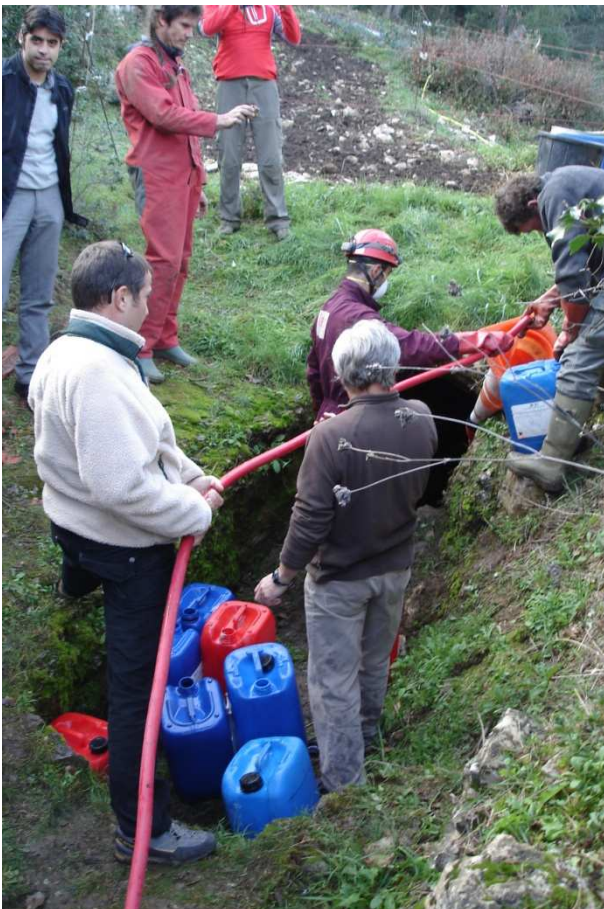
Photo 13 : Injection de l'acide amino G en solution à partir de l'entrée de l'embut
