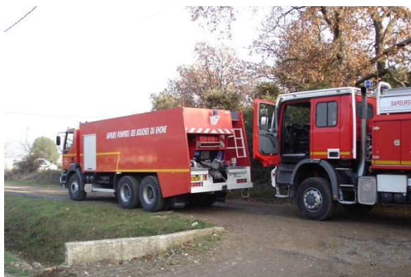
Photo 15 : Camions pompiers apportant l'eau ( 14 + 6 \text{ m}^3 ) pour la "chasse" de la solution d'acide amino G injectée
