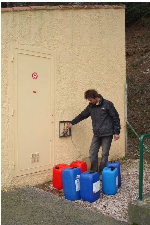
Photo 4 : Remplissage en eau brute des bidons pour le mélange avec l'acide amino G
