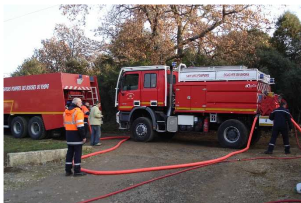
Photo 15 : Camions pompiers apportant l'eau ( 14 + 6 \text{ m}^3 ) pour la "chasse" de la solution d'acide amino G injectée
