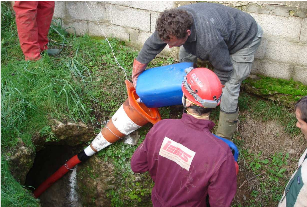
Photo 13 : Injection de l'acide amino G en solution à partir de l'entrée de l'embut
