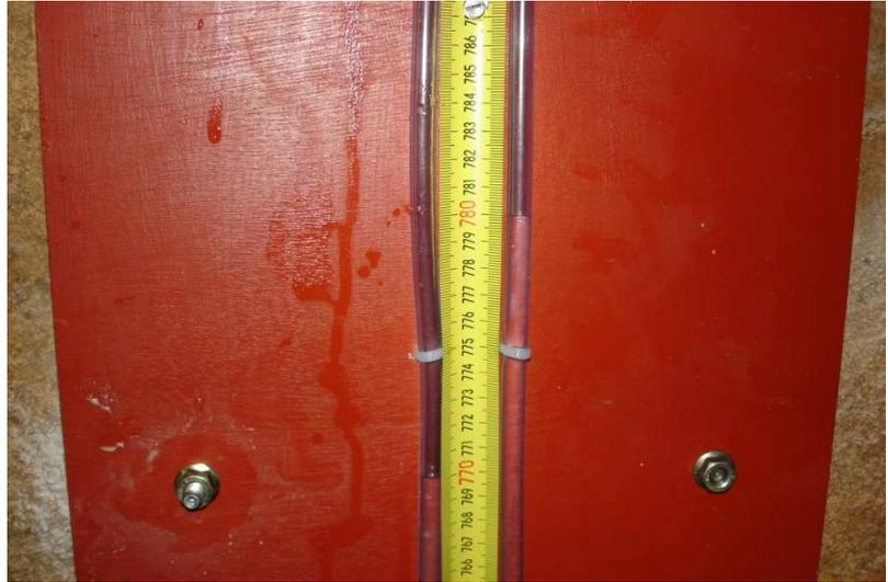
Mesure de la dénivellation Aval-Amont sur le niveau à eau le 30/05/10 – 13h50 (heure d'été) : 10 cm
