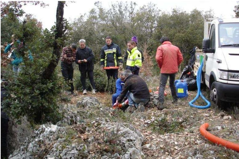
**Photo 15 : Injection des 12 m<sup>3</sup> d'eau des pompiers dans la perte de la Revengudo à partir de la surface**
