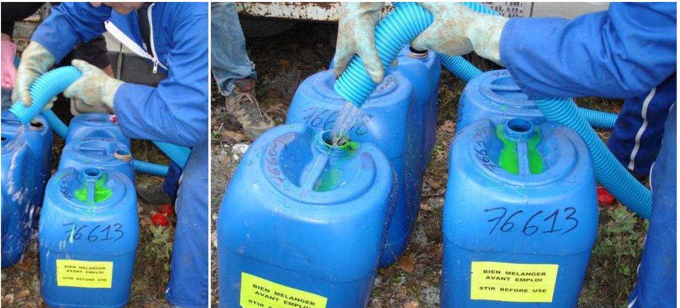
**Photo 13 : Rincage des bidons après injection. L'eau est verte, teintée par la fluorescéine**
