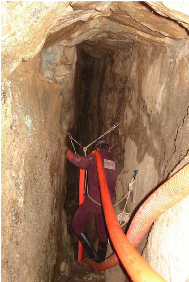
Photo 16 : Injection dans l'embut de  $20 \text{ m}^3$  d'eau amenée par camions pompiers pour pousser la solution d'acide amino G injectée
