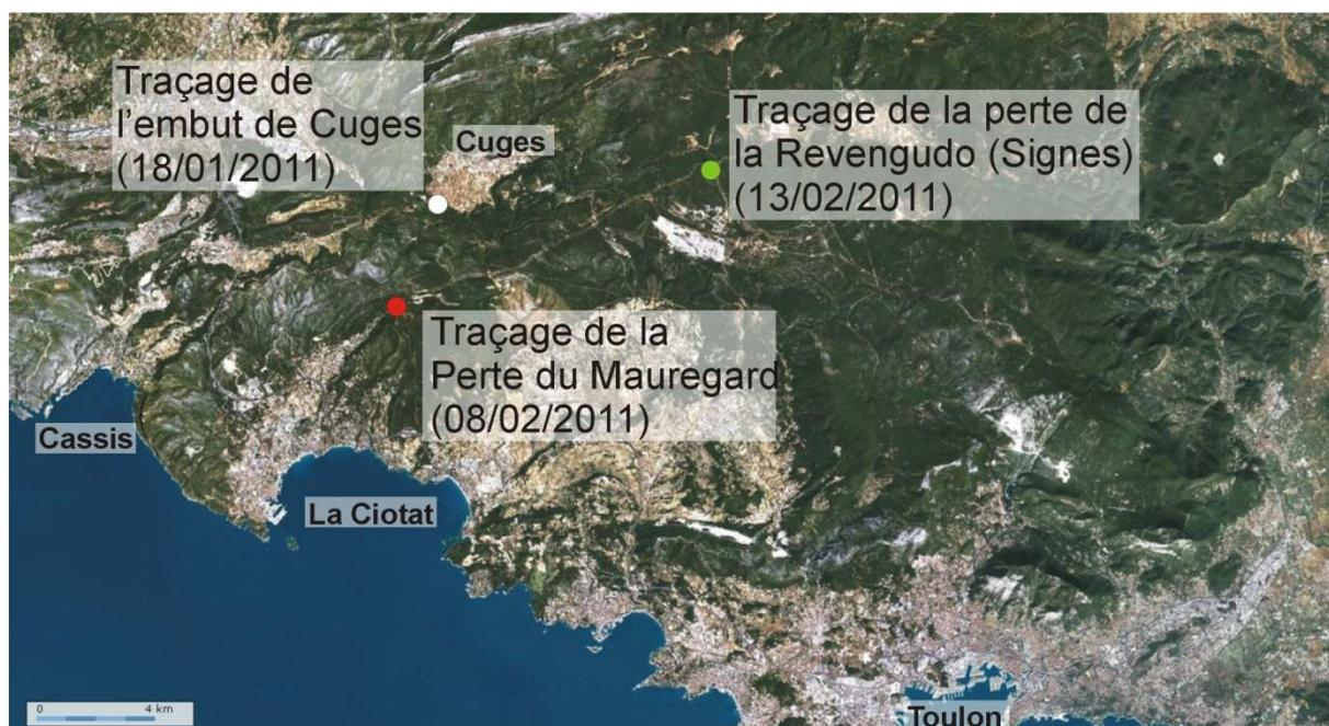
**Figure 4 : Photo aérienne de l'unité du Beausset et localisation des 3 injections du multitraçage KarstEAU 2011.**
