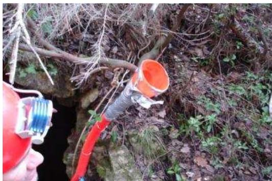
Photo 3 : Le tuyau de 50 mm de diamètre pour l'injection du traceur, avant son déplacement au raz de l'entrée de la cavité
