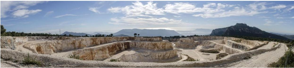
Fig. 46 : La carrière de Fiéraqet directement en amont des sources de Dardennes, recoupe des structures d'altération bréchiées imprégnées de sédiments rouges. Ces structures et la fracturation assure le drainage par infiltration à l'échelle du carreau (photo : C. Baudement).
