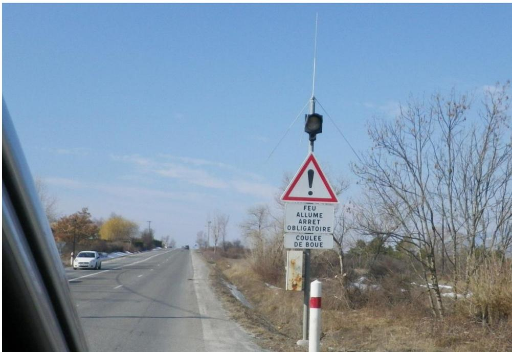
Photo du dispositif d'alerte de coulée boueuse du torrent de Boscodon sur la route RN94 (cliché B. Arfib-A. Mirlit 26/02/2013)
